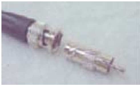
BNC 接頭轉接成 RCA 接頭
